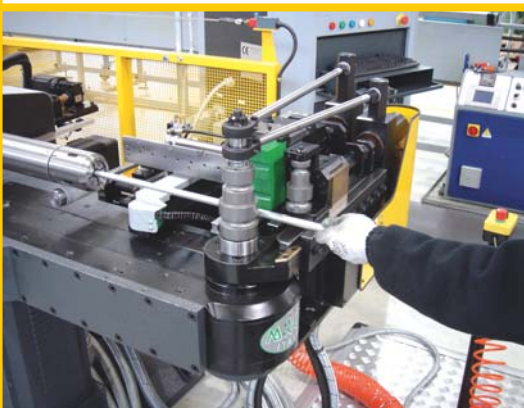
Zmienne Promienie Możliwość wykonania dwóch różnych promieni na tej samej rurze
